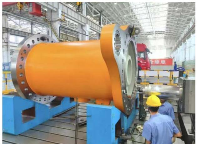
术、喷嘴管超大长径比小深孔加工技术、喷嘴管内外筒体车镗复合高精度加工技术、喷嘴碟簧高可靠性装压技术等诸多行业难题。本次成功研制的首台喷嘴零部件加工和整体装配试验的指标达到精品标准，多个核心部件制造精度达到了微米级。
