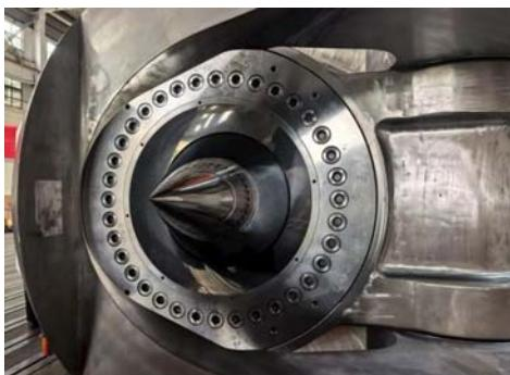
喷嘴是冲击式水电机组的重要部套，其作用为将水的势能转换成射流的动能，并通过调节喷针的开度来控制水电机组出力，其水流稳定性能、结构应力水平、疲劳性能、结构刚度、制造质量等直接关系到整个电站的安全性和可靠性。
