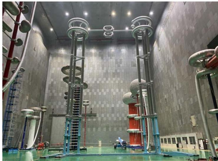
藏粤直流工程送端昌都换流站位于海拔 4300 米区域，是目前世界海拔最高的换流站。在极端环境下，电力设备面临严峻技术挑战：高海拔空气稀薄导致绝缘强度显著下降，4000 米及以上海拔的绝缘特性研究不足、标准不完善，常规设计难以满足需求；同时，4500 米海拔设备绝缘修正标准缺失、长间隙绝缘设计数据空白等问题突出，进一步增加了研发难度。
